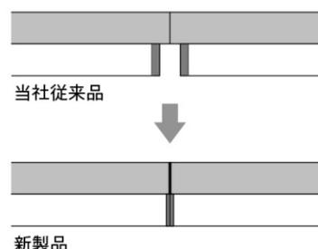
コンパクト設計を実現しつつ、均一発光を実現し、連結時も灯具の隙間ができにくい構造と灯具端部のキャップを最小限の設計とすることでシームレスな光をつくり出します。建築空間の構成要素として位置づけられる直線美を演出します。
